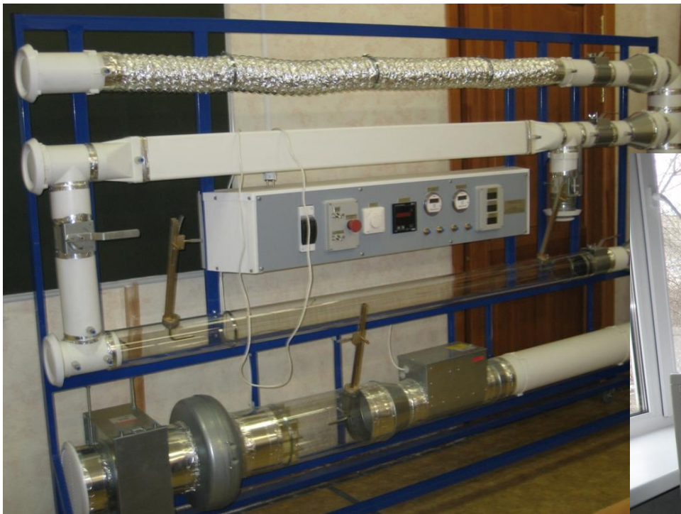
Исследовательский стенд «Вентиляционные системы»
